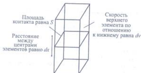
Рис. 13.5. Определение коэффициента вязкости \eta . Сила сдвига между двумя элементами равна \eta(dv/dx) \cdot S , что определяет, таким образом, величину \eta
